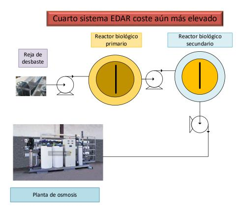
En este, al terminar el proceso, el agua tratada se pasa por una planta de filtración (osmosis), de forma que las plantas se van perfeccionando, pero encarece mucho la planta y los rendimientos no son los óptimos, bien sea porque los filtros se obturan con facilidad y cambiarlos o limpiarlos tantas veces reduce su capacidad, o por el coste del sistema.
