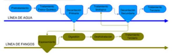
El pretratamiento es un conjunto de tratamientos físicos, que separan la contaminación que está flotando o en suspensión en las aguas. Se realiza para evitar que esas partículas dañen los equipos posteriores y consiste en el desbaste, desarenado y desengrasado.
